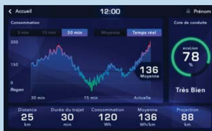
Figure 2 : Écran de conduite sur la console d'information multifonctions pour le conducteur
